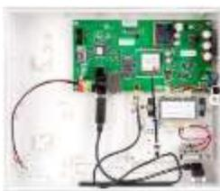
JA-101KR-LAN kontrol paneli JABLOTRON 100 serisi sistemin temel panelidir. Esnek sistem yapılandırma seçenekleri ile ufk ve orta ölçekli şirketler ile küçük tip villa ve evler için hem kablolu hem de kablosuz çözümler sunabilir. Tüm sistem F-Link yazılımı ile programlanabilir.
